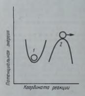
Рис. VIII.1. Схема пояснение различия между молекулой и активированным комплексом:
