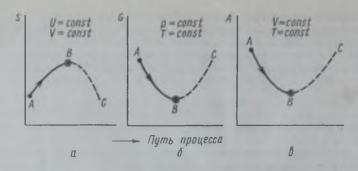
Рис. II.8. Измерение энтрошии (a), энергии Гиббса (б) и энергии Гельмгольца (в) при протекании процесса:
